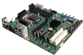
SYM86603VGGA-Q370 · 酷睿8/9代Q370 ATX工业母版 · 支持i9处理器(Max 95W) · 支持同/异步三显 · 1个PCIe x16插槽 · 6USB3.0/7USB2.0 · 双英特尔千兆网口
